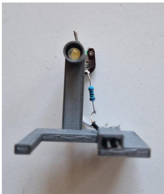
Obr. 3.6 – Zdroj využívající teplou bílou LED diodu s variabilním jasem vyvinutý pro spektrofotometr V2 (viz 3.3.3)
