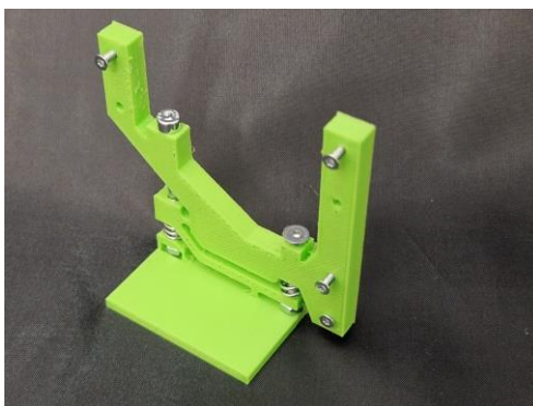
Obr. 3.70 – 3D tisknutý úchyt pro desku lineárního senzoru na nastavitelné platformě
