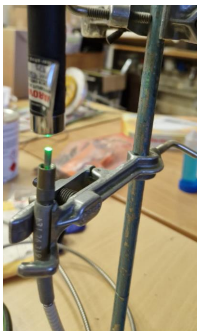
Obr. 3.8 – Využití laserového ukazovátka (532 nm) na kalibraci spektrometru
