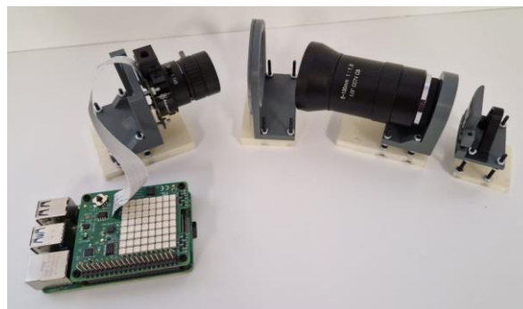
Obr. 3.68 – Vyvinutá aparatura na používání PiCamery HQ a velkých objektivů jako kolimačních a fokusačních prvků
