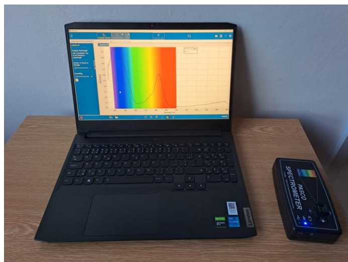
Obr. 2.5 – Soustava pro měření s Pasco PS-2600
