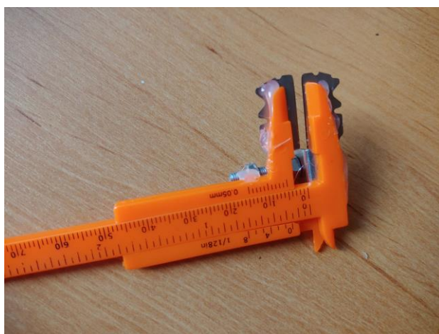
Obr. 3.18 – Vývojová verze štěrby s posuvnou vnitřní šířkou
