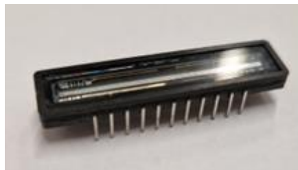
Obr. 3.27 – Lineární senzor Toshiba TCD 1304AP
