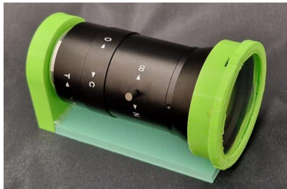
Obr. 3.67 – Sestrojený kolimátor s difrakční mřížkou
