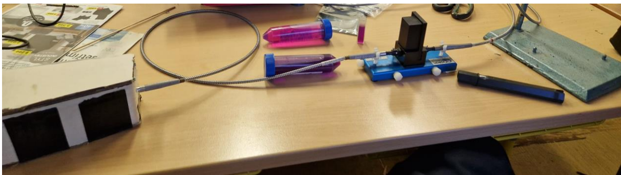
Obr. 3.47 – Měřicí aparatura pro testování spektrofotometru V1 využívající zapůjčené součástky Oceanoptics
