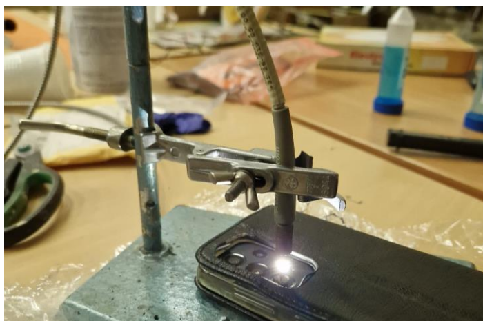
Obr. 3.4 – Blesk mobilního telefonu používaný jako zdroj
