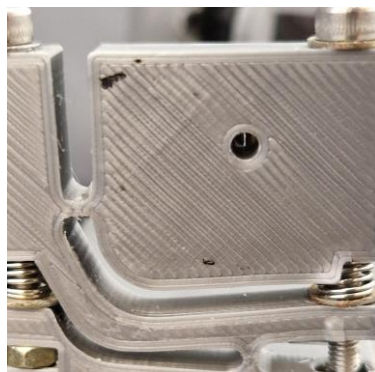
Obr. 3.17 – štěrbina z vnější strany s prostorem pro připojení optického vlákna
